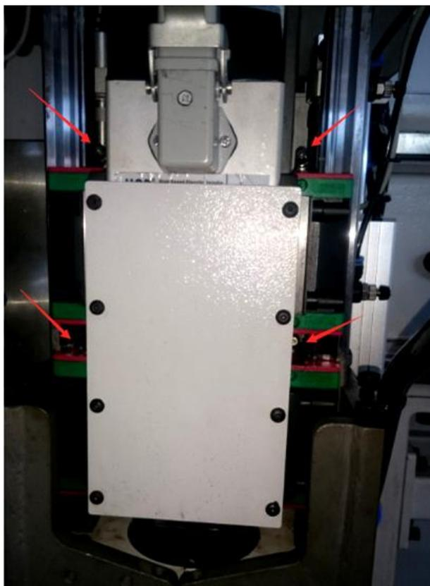
(5) 气排钻齿轮箱需要定期从加油嘴（下图所指处）加油润滑，一般为每 40 工作小时加润滑油脂 5cc。
